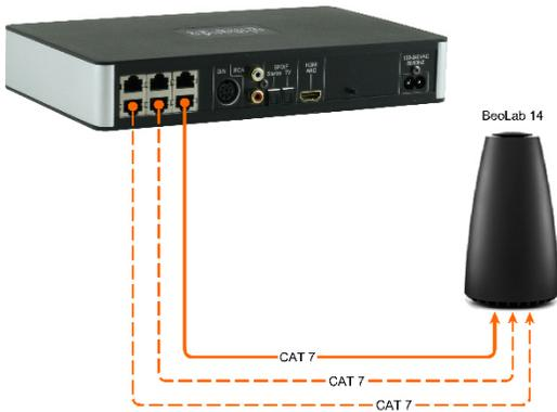
Auch BeoLab 14 können hier problemlos angeschlossen werden (Center und Subwoofer werden getrennt auf beiden Audio-Signalen der Powerlink-Buchse ausgegeben).
