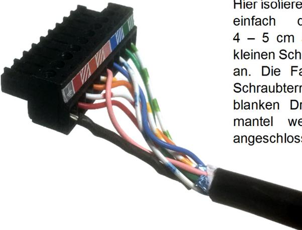
Hier isolieren Sie am offenen Ende des Kabels einfach die einzelnen Drähte etwa 4 – 5 cm ab und schließen Sie mit einem kleinen Schraubendreher am Schraubterminal an. Die Farbkodierung ist direkt auf dem Schraubterminal aufgedruckt. Die drei blanken Drähte ohne farbigem Kunststoffmantel werden verdreht und am GND angeschlossen.
