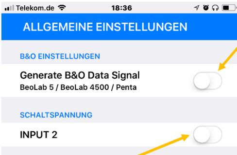
Hier legen Sie fest, ob Daten-Signale an die B&O Lautsprecher ausgegeben werden sollen (eingespeiste Daten von angeschlossenen B&O Geräten oder vom almando Gerät selbst generierte Daten für Fremdgeräte). Dies ist nur nötig, wenn BeoLab 5, BeoLab 4500 oder BeoLab Penta angeschlossen sind. Andernfalls sollte die Erzeugung des „Datensignal“ deaktiviert bleiben (Standard-Einstellung).
